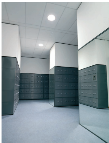
Binnenaanzicht van een daglichtbuis in een kluisjesruimte van een school
